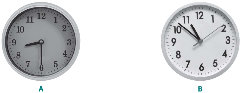
Fig. 1.1 Esempio di strumenti per la misura degli intervalli di tempo. In (A) la minima variazione misurabile è un minuto, e quindi l'incertezza nell'orario misurato è maggiore che in (B), strumento per il quale è possibile stabilire l'orario con un'incertezza di un secondo.
