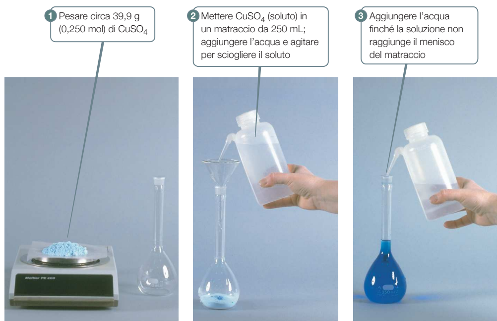
▲ Figura 4.15 Procedura di preparazione di 0,250 L di una soluzione 1,00 M di \text{CuSO}_4 .
