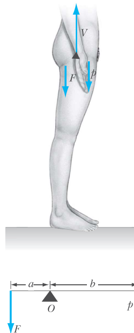
▲ Figura 4.8 Articolazione del tronco e corrispondente schema della leva.
