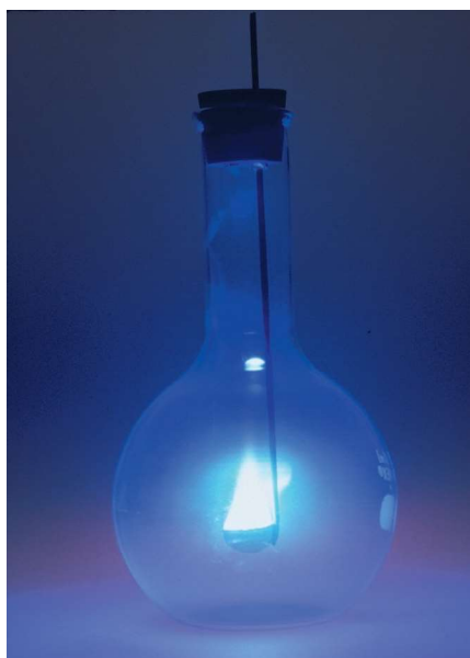
(b) Reazione dello zolfo (nella spatola) con l'ossigeno, per dare diossido di zolfo \text{SO}_2 .
