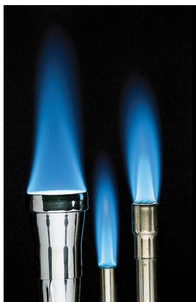
Figura 3.3 Una reazione di combustione. Il propano, \text{C}_3\text{H}_8 , brucia per dare \text{CO}_2 e \text{H}_2\text{O} . Questi ossidi semplici sono sempre i prodotti della combustione completa degli idrocarburi.
