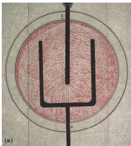
Figura 4.19 Linee di campo in un pozzo di Faraday piano (a) e tra due conduttori cavi concentrici (b).
